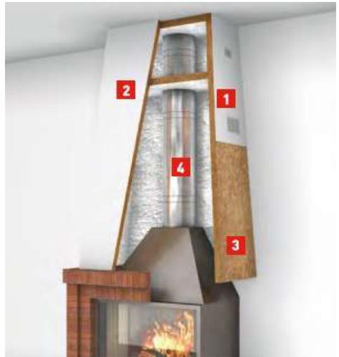
Solución para el aislamiento térmico de chimeneas, consistente en colocar los paneles aislantes de lana de roca FIREROCK 910.219 en la parte posterior del hogar y en el interior de la campana. El objetivo es aislar la pared del calor generado a la que se adosa la chimenea para evitar fisuras, riesgos de quemaduras al tocar la campana y mejorar el rendimiento térmico de la instalación.
