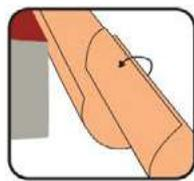
8. Girar el canalón superior encajándolo con el inferior con la ayuda de la pestaña posterior.
