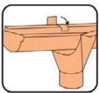
10. Girar la salida sobre el canalón y ajustar las lengüetas posteriores de la misma.
