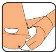
9. Hacer un orificio de evacuación y colocar la salida universal encajando la pestaña en el rizo.
