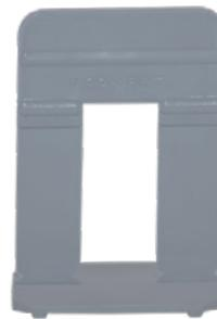
El calzo para piedra Peygran se ha diseñado especialmente para granito, piedra y mármol. Permite trabajar espesores de entre 16 y 30 mm. Ofrece mayor resistencia que el calzo normal, para poder así ajustar formatos pesados. Disponible en 80 uds y 300 uds.
